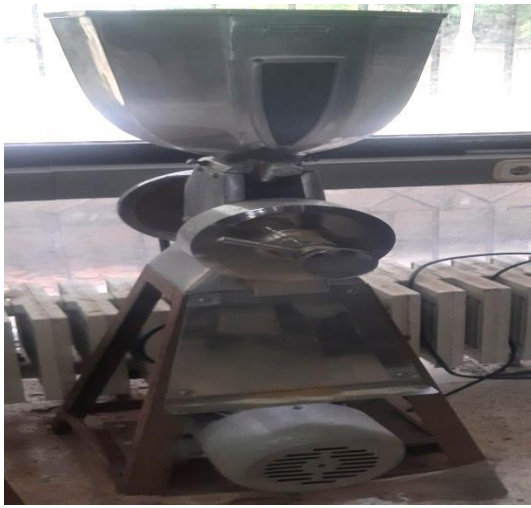
الشكل (1): المطحنة المستخدمة لطحن الحمص.
